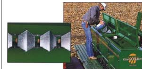
Containerile de sămînță cu fund în forma de V sunt cu design care permite curățenie regulată și completă a containerului de sămînță.
