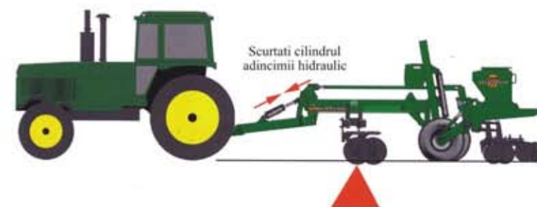
Mai multă greutate este aplicată la coulter-uri (cutite de disc)
