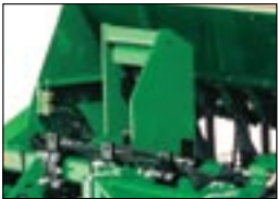
Установленные скобы для крепления дополнительных грузов
