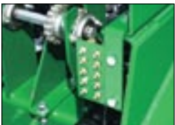
Центральная консоль для смазки режущих дисков
