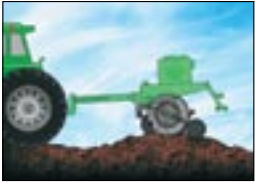
Конструкция с боковыми транспортно-приводными колесами
