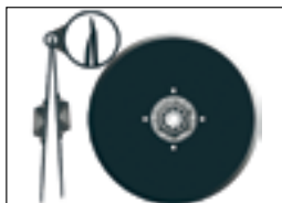
Офсетно установленные диски сошника диаметром 38 см
