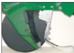
Семенная трубка, используемая на пропашных сеялках
