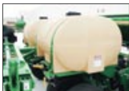
Емкость для жидких удобрений объемом 1510 литров
