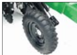
Привод насоса для внесения удобрений от опорного колеса
