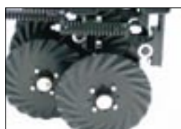
Шахматное расположение режущих дисков
