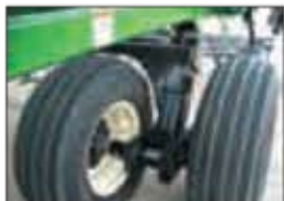
Усиленный плавающий тандем
